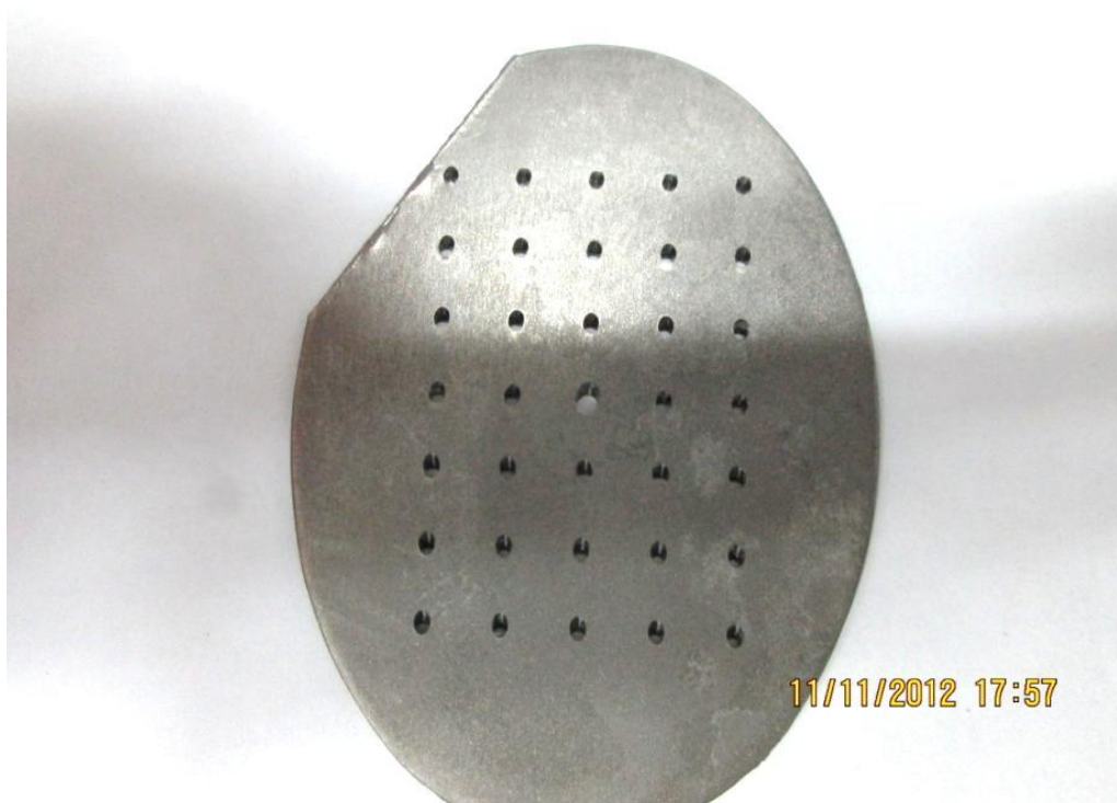
איור 3 מסך s1 (צד קדמי) לפני התקנה, ה"ביס" בצד ימני נצרך כדי למרכז את המסך.
