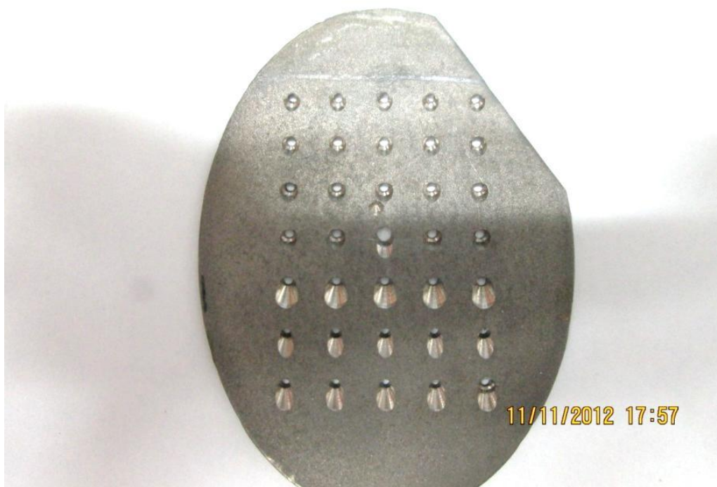
איור 2 מסך s1 (צד קדמי) לפני התקנה, ה"ביס" בצד ימני נצרך כדי למרכז את המסך.
