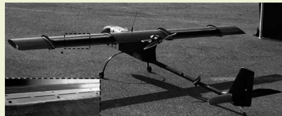
הטיסן מוכן לניסוי טיסה. ההגדלה בשמאל למטה מציגה את פתחי הזרקת הערבולים ממפעילי הזרימה הנמצאים בתוך הכנף.
