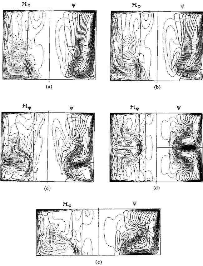
FIG. 14. The same as Fig. 11. Corotation,  $\gamma=1.5$ . (a)  $\xi=0.2$ ,  $\text{Re}_{\text{cr}}=3249$ ; (b)  $\xi=0.4$ ,  $\text{Re}_{\text{cr}}=2905$ ; (c)  $\xi=0.6$ ,  $\text{Re}_{\text{cr}}=4493$ ; (d)  $\xi=1$ ,  $\text{Re}_{\text{cr}}=3843$ ; (e)  $\xi=1$ ,  $\text{Re}_{\text{cr}}=3845$ , symmetric case.
