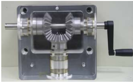
איור 4.18 חתך ודגם של התמסורת החד-כיוונית כפי שתאורה בפרק השני
