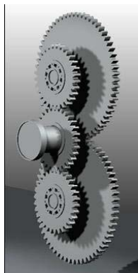
איור 4.10 חתך ודגם של התמסורת החד-כיוונית כפי שפותחה בפרק השני
