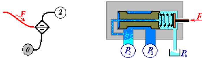
איור-29.A: שסתום בקרת לחץ וייצוג גרפי שלו כמקור פוטנציאל תלוי.
